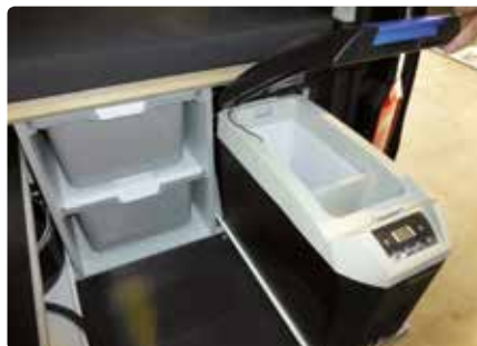
Die 16-l-Kompressor-Kühlbox ist herausziehbar sowie herausnehmbar und wird vom 12-V-Bordnetz gespeist.
