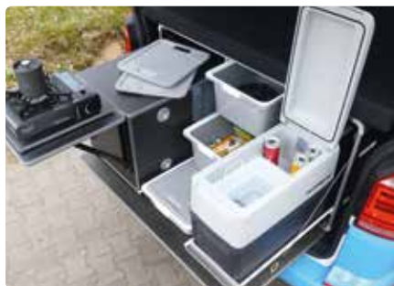
Die optionale 21-l-Kompressor-Kühlbox ist herausziehbar sowie herausnehmbar und wird vom 12-V-Bordnetz gespeist.
