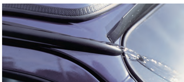
Wasserableitung über Spoilerprofil
