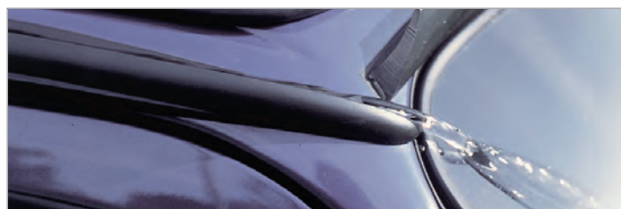
Wasserableitung über Spoilerprofil
